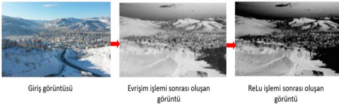
Şekil 3.6 : Bir ESA modelinde evrişim işlemi ve ReLU işleminin giriş görüntüsüne yaptığı etki [52].
