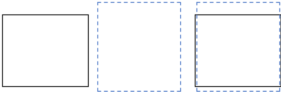
Şekil 4.3: Düz çizgi fiziksel alanı, kesikli çizgi ise sanal ortamı temsil etmektedir. Sanal ortamın boyutu fiziksel alanı geçtiği için bu tasarım uygun değildir.
