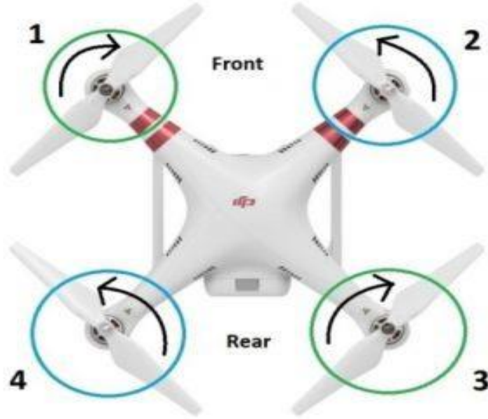
Şekil 2.3 : Çapraz konfigürasyonlu quadrotorda rotorların dönüş yönü.
