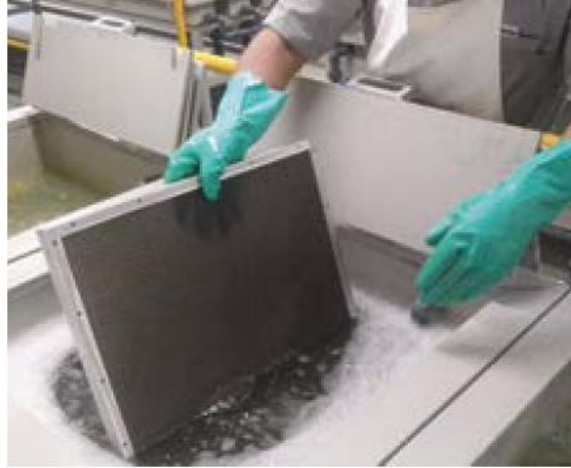
Şekil 2.73: Hava deliklerine kaplama (plating) uygulanması (Parker Co.) [Url-43].
