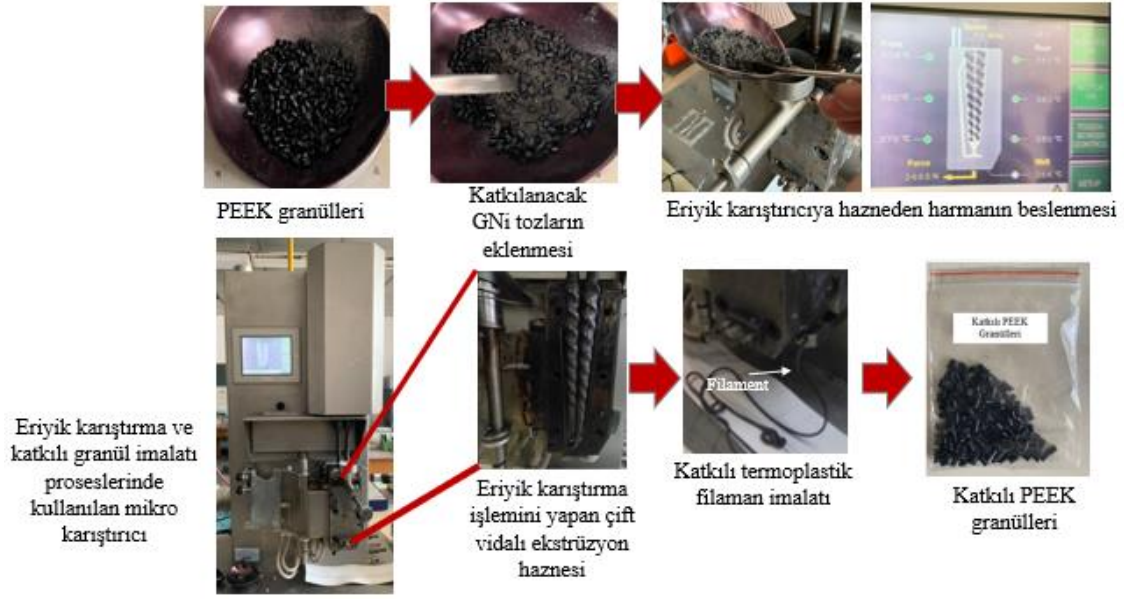
Şekil 5.1: PEEK granüllerine GNi kakılama prosesleri.
