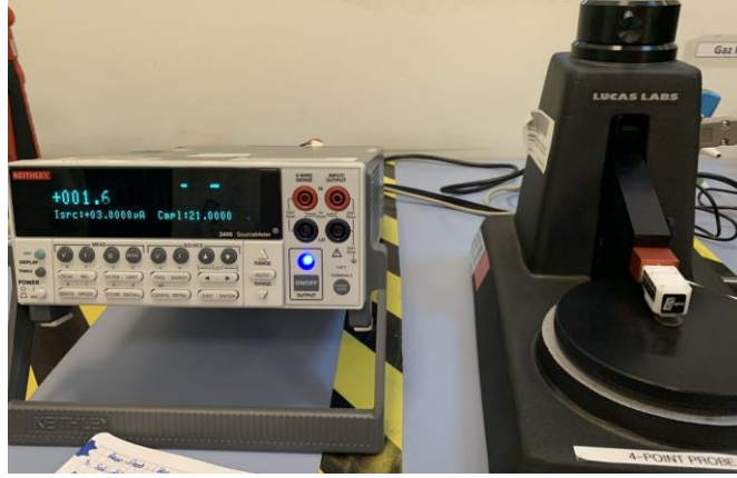
Şekil 3.9: Epoksi matrisli kompozit numunelere Dört Nokta Prob ile ölçüm alma denemeleri.
