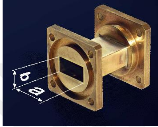
Şekil 2.7: 18- 26,5 GHz frekanslarında çalışan bir dikdörtgen dalga kılavuzu ve kesiti [Url-14].
