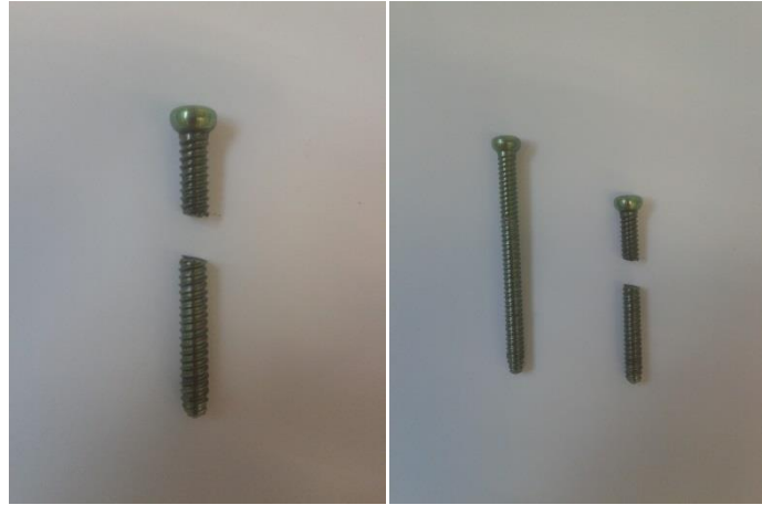
Şekil 4.1. Geleneksel sisteme ait distal vida kırığı örnekleri
