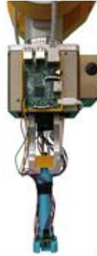
Şekil 3.8 : Raspberry Pi ve uzaklık algılayıcıların robot üzerine yerleştirilmiş hali.
