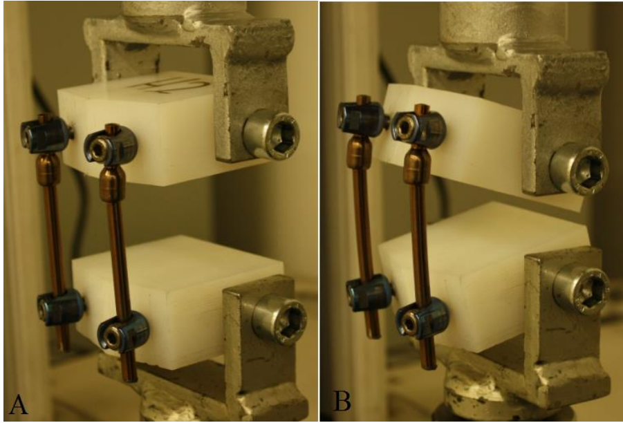
Şekil 3.3. Yarı hareketli sabitleme numunesinin basma eğme deneyinde çekilen fotoğrafları. (a) deney öncesi, (b) deney sonrası.
