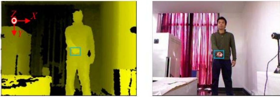
Şekil 2.22- Derinlik görüntüsünden IMU koordinatlarının elde edilmesi (sol), Camshift algoritması kullanılarak elin takip edilmesi (sağ) [59].
