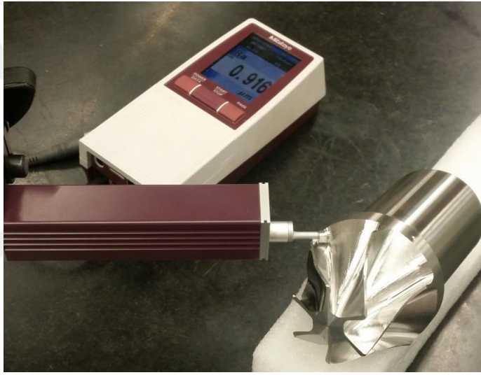
Şekil 6.3 : Mitutoyo Surftest SJ-210 yüzey pürüzlülüğü ölçüm cihazı.
