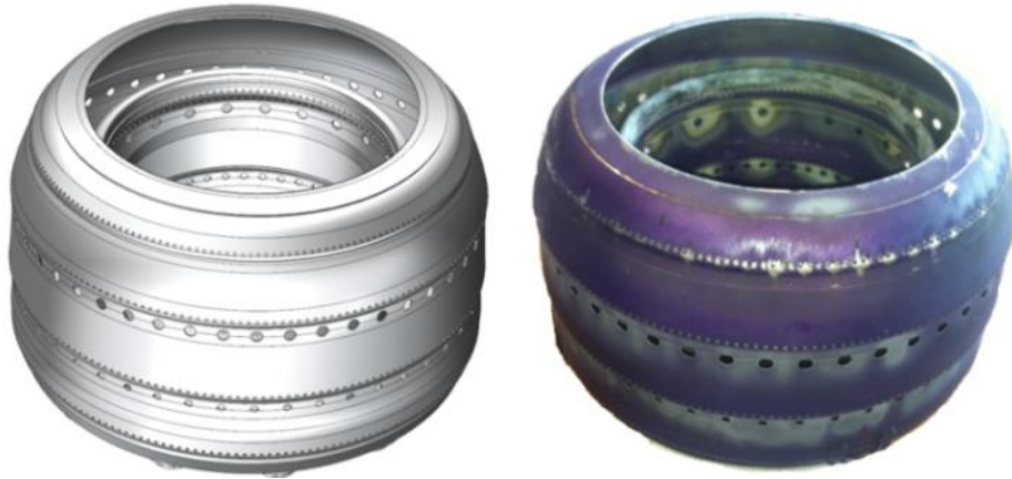
Şekil 3.1: RQL tipi yanma odası CAD modeli ve üretilmiş gerçekteki geometri görüntüleri.
