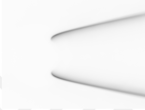
Şekil 3.17: Alevin anlık (instantaneous) CH* kimyasal ışıldama görüntüsü, \phi=0.75 , RPM=0.
