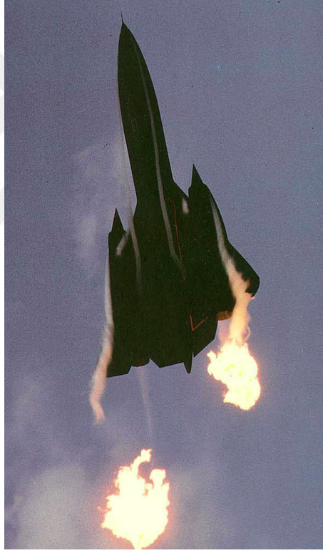
Resim 1.1: Yüksek performans SR-71 uçağında alevin tutunamaması sonucunda gerçekleşen alev süpürülmesi [48].
