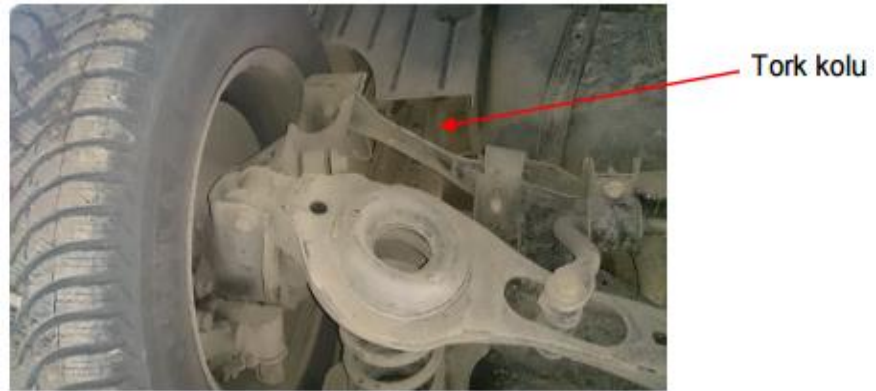
Şekil 1.1: Tork kolunun arka süspansiyon sistemindeki yeri (2011 Ford Focus)
