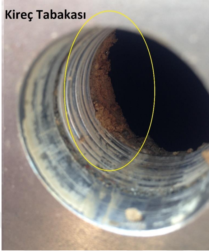
Şekil 2.6: Cebri borudaki kireç tabakası.
