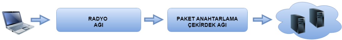
Şekil 1.3 : Uçtan uca servis kalitesini ölçen sistemin yapısı.
