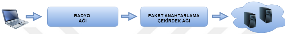
Şekil 4.1 Uçtan uca servis kalitesi yapısı.
