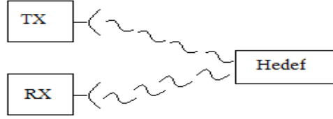
Şekil 1.1: Basit radar formu.
