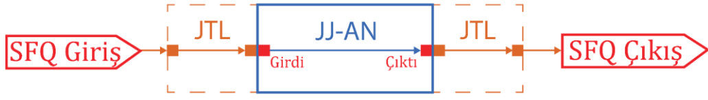
Şekil 3.28 : JJ-AN ile JTL devrelerinin uyumluluk testi şeması
