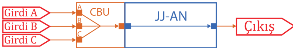
Şekil 3.8 : ‘ÇOĞUNLUK’ operasyonunu gerçekleştiren JJ-AN devre şeması
