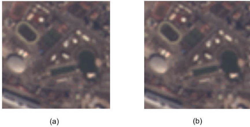
Resim 2.2: Ankara (a) çoklu spektral görüntü ve (b) Gramm-Schmidt metodu ile pankeskinleştirilmiş görüntü
