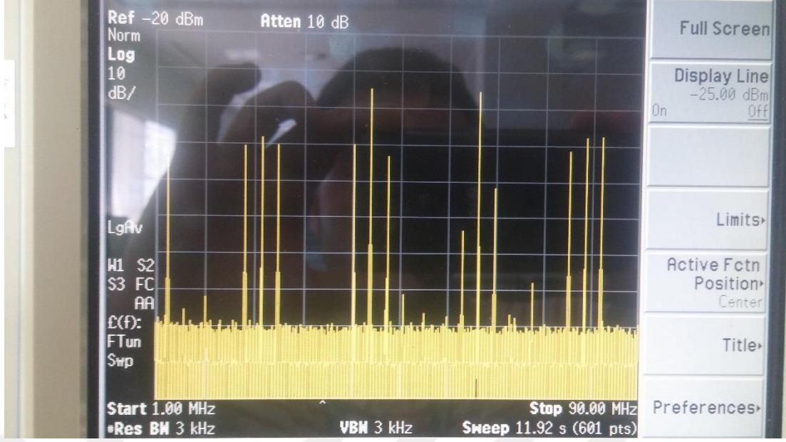
Şekil 4.8 x(t) işareti ile p(t) işaretinin rastgele demodülasyonu sonucunda [1,90] MHz bandındaki oluşan örtüşme/birikme.
