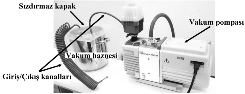
Resim 6.4 : Hızlı takımlamada kullanılan vakum ünitesi.
