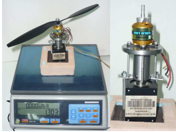
Şekil 2.15. b ve d katsayılarının bulunması için kurulan deney düzeneği, [36]
