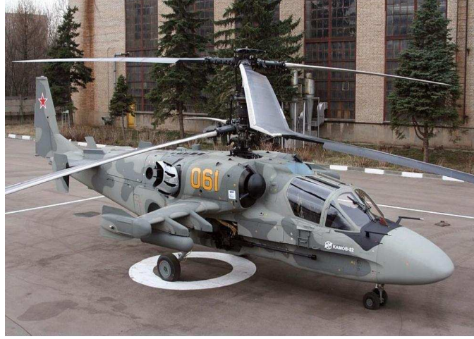
Şekil 1.10. Çift rotorlu eşeksenel düzenleşim, [7]
