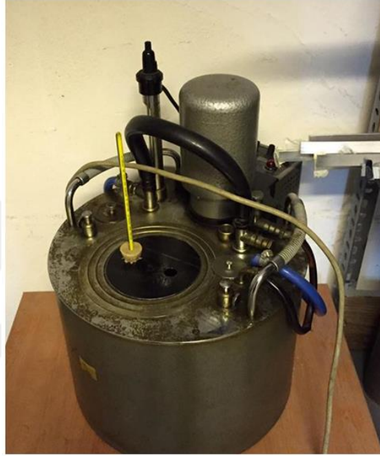
Resim 3.14 : Sıcaklık kalibrasyonları için kullanılan yağ banyosu.
