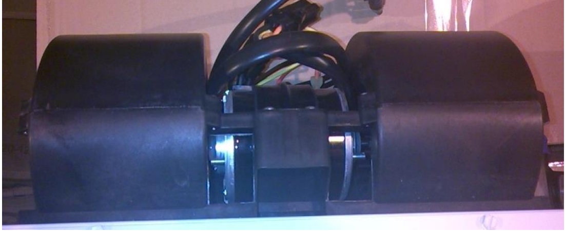
Şekil 1.6: Isı deęiřtirgeci üzerindeki elektrikli hava fanları
