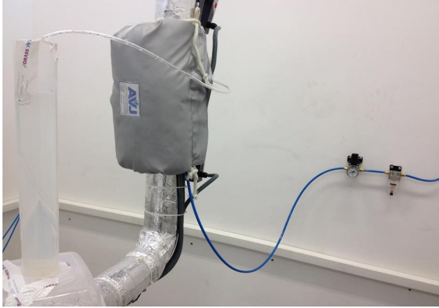
Şekil 5.8 Hava parçalamalı nozul için basınçlı hava sistemi
