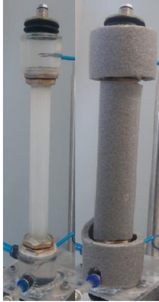
Resim 2.5: Sistemin izolasyonsuz (solda) ve izolasyonlu (sağda) haldeki resimi
