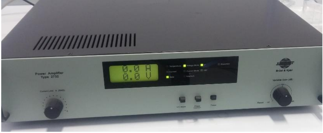
Resim Ek.3: Sürücüden gelen sinyalleri arttıran amfi (Yükseltici)
