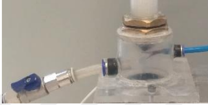
Resim 2.3: Isılıçift bağlantı girişleri (sağda) ve alttan doldurma vanası (solda).
