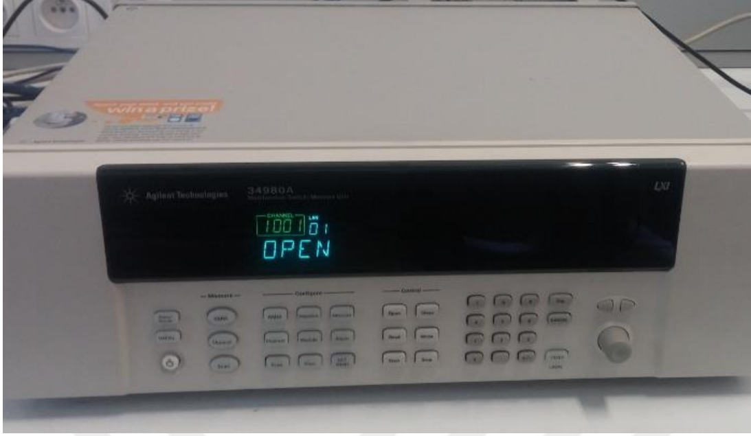
Resim Ek.5: Sıcaklık verilerinin toplandığı, veri toplayıcı cihaz.
