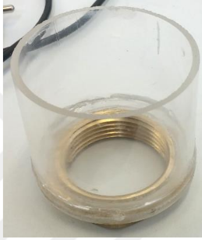
Resim 2.1: Deneysel düzeneğinde kullanılan şeffaf akrilik rezervuar.
