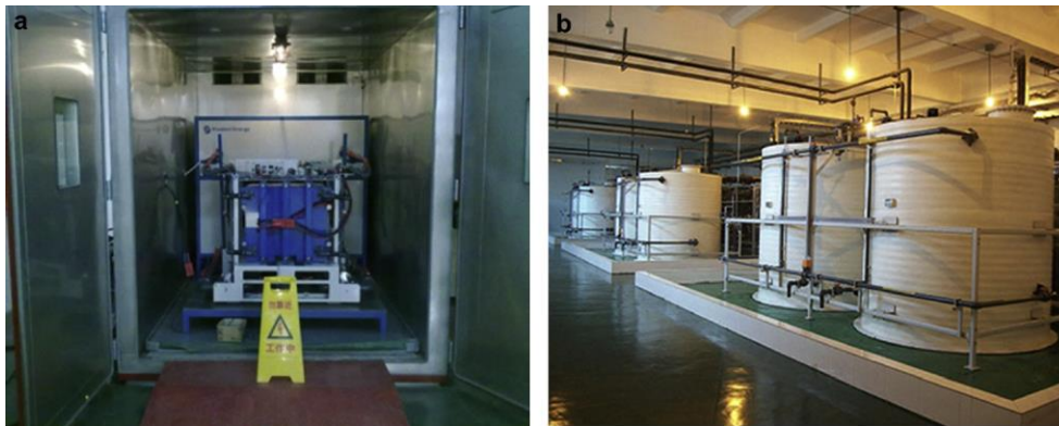
Şekil 2.26 : (a) 5 \text{ kW} , 2 \text{ kWh} ve (b) 0.5 \text{ MW} , 1 \text{ MWh} güç ve kapasiteli VRAB sistemleri (Jizhong, 2013).
