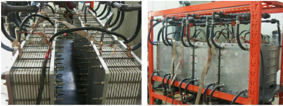
Şekil 2.25 : 4x2 (seri x paralel) konfigürasyonunda 8 adet 1 \text{ kW} 'lık yığın modülleriyle oluşturulmuş 10 \text{ kW} sınıfı vanadyum redoks akış bataryası yığını).
