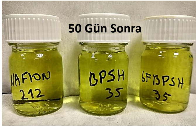
Şekil 4.36 : V 5+ çözeltisi içerisinde bekletilen 6FBPSH 35, BPSH 35 ve N212 TM zarlarının 50 gün sonraki görüntüsü.
