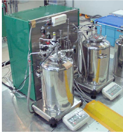
Şekil 2.8 : 120 \text{ L H}_2 \text{ dk}^{-1} hidrojen üretim hızına sahip sistem (Kojima, 2004).
