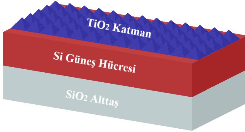
Şekil 1.9: Işık tuzaklama amaçlı kare tabanlı piramitlerden oluşan TiO 2 katman ile kaplanmış Si güneş hücresi tasarımı. Altaş olarak SiO 2 kullanılmıştır.
