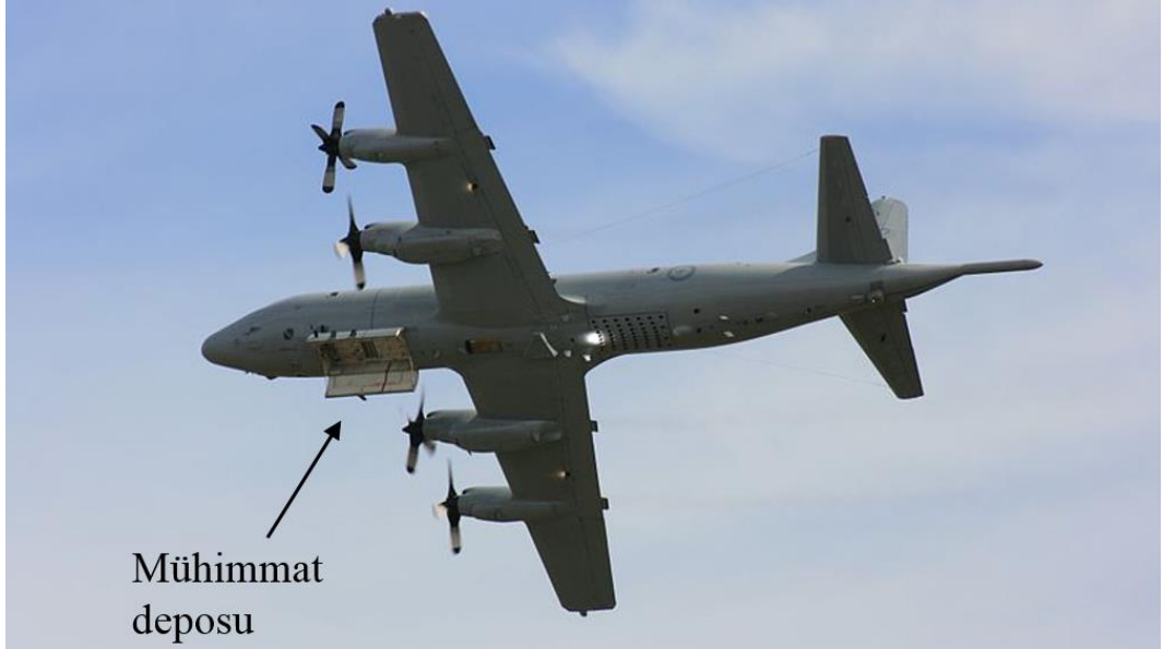
Resim 1. 1 : AP-3 Orion uçağında mühimmat deposunun açılması
