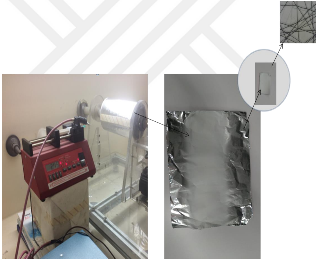
Şekil 2.12 : Elektroğirme yöntemiyle fiber oluşması.
