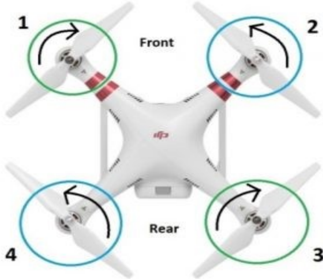
Şekil 2.3 : Rotor çiftlerinin dönüş yönlerinin gösterimi.
