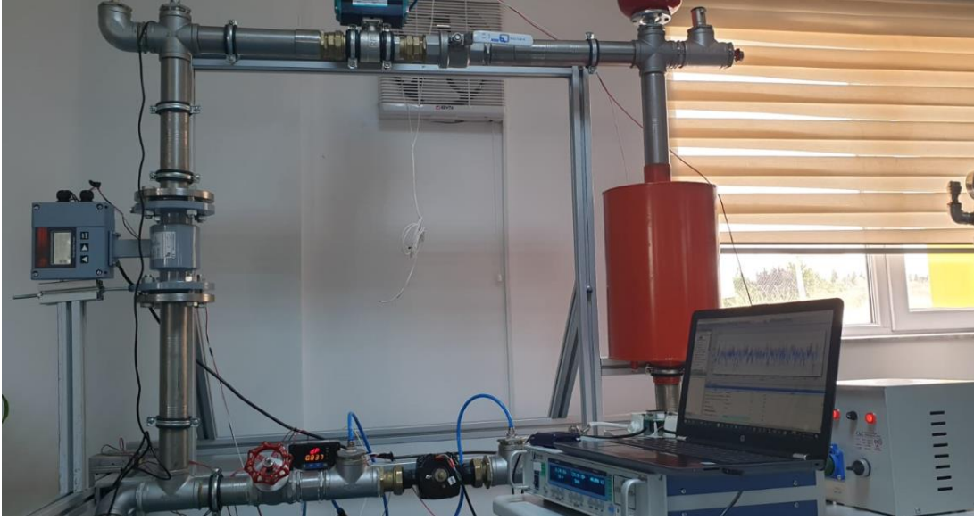
Resim 5.1 : Hidrolik Performans Test Standı
