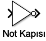
Şekil 8.17: Not(Değil) kapısı bloğu
