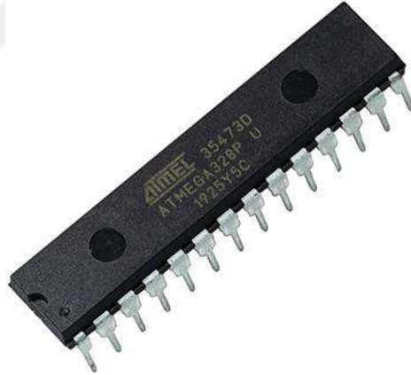
Şekil 6.1: ATmega328P kontrolcü donanımı[30]
