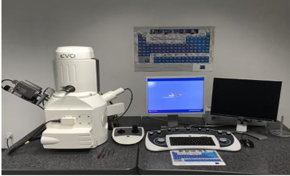
Şekil 2.3: Taramalı elektron mikroskobu (SEM).
