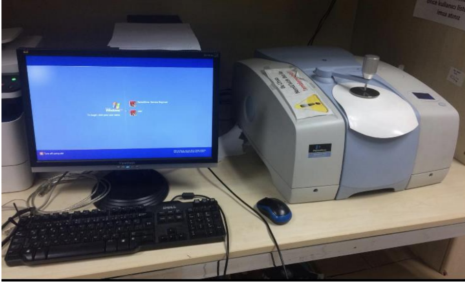
Şekil 2.4: Fourier dönüşümlü kızıl ötesi spektroskopisi cihazı (FTIR).
