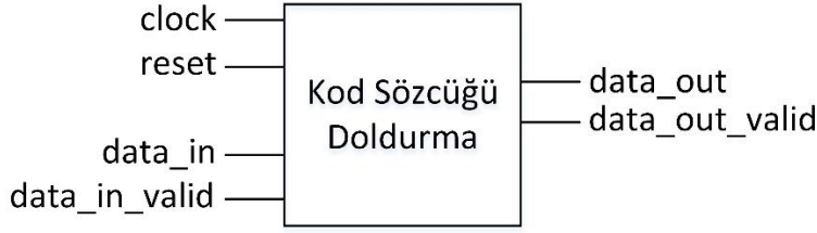
Şekil 4.19 : Kod sözcüğü doldurma bloğu FPGA tasarımı arayüz sinyalleri.
