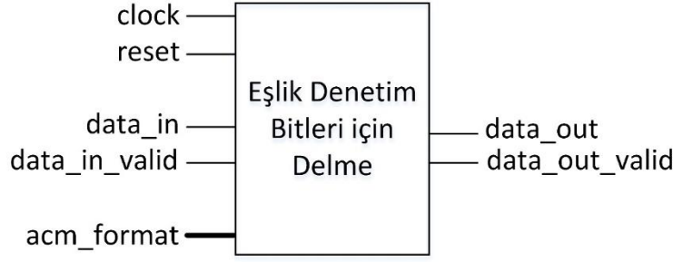
Şekil 4.12 : Eşlik denetim bitleri için delme bloğu FPGA tasarımı arayüz sinyalleri.
