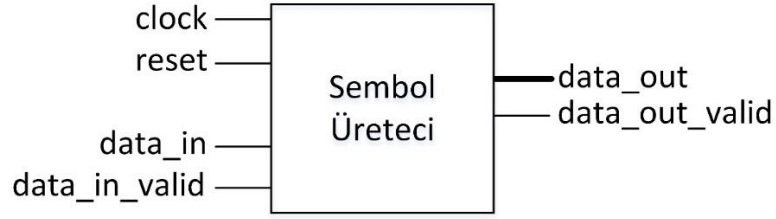
Şekil 4.15 : Sembol üretici bloğu FPGA tasarımı arayüz sinyalleri.
