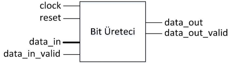
Şekil 4.18 : Bit üretici bloğu FPGA tasarımı arayüz sinyalleri.
