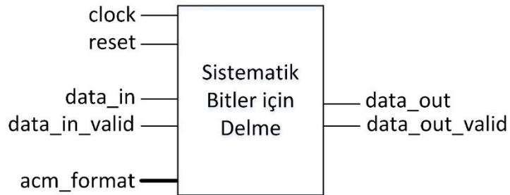
Şekil 4.11 : Sistematik bitler için delme bloğu FPGA tasarımı arayüz sinyalleri.
