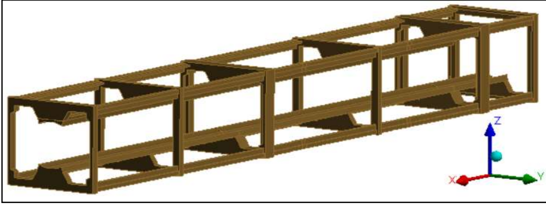
Şekil 3.37 : Çözüm Ağı Yakınsaması için sadeleştirilmiş kanister modeli
