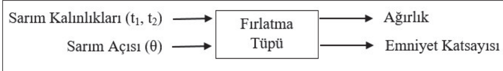
Şekil 3.6: ANSYS Modelinde Kullanılan Girdiler ve Çıktılar
