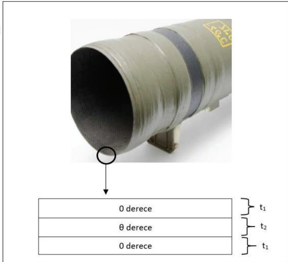
Şekil 3.1: Fırlatma Tüpü Katman ve Sarım Açılı
