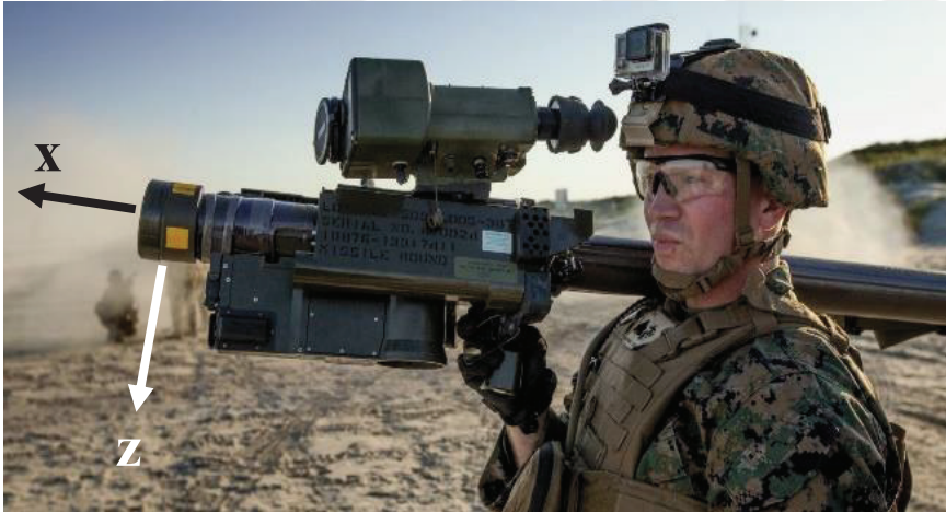
Şekil 3.7: Fırlatma Tüpü için Koordinat Eksenini [54]
