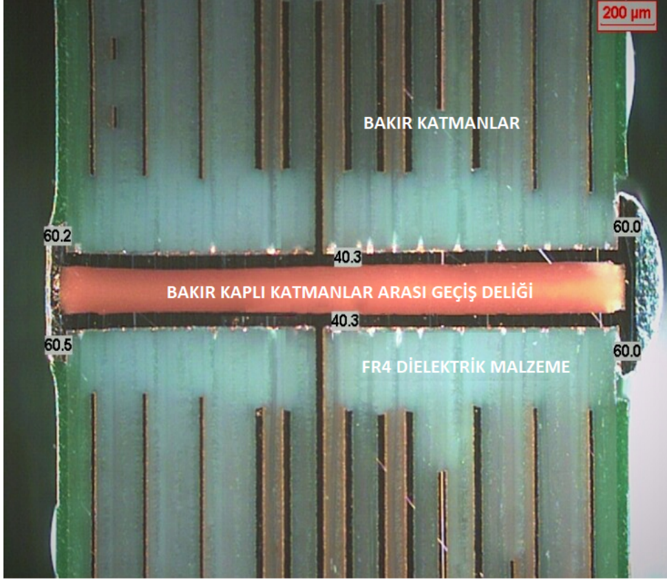
Resim 2. 3: 16 katlı BDK katman kesit görünümü, fotoğraf Leica DM6000M serisi mikroskop ile çekilmiştir.
