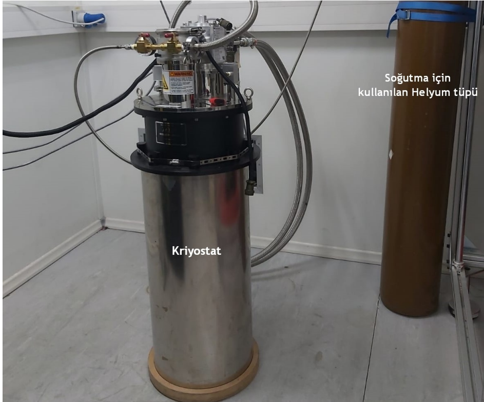
Şekil 1. 6: İçerisine probun yerleştirileceği kriyostat gösterilmiştir.
