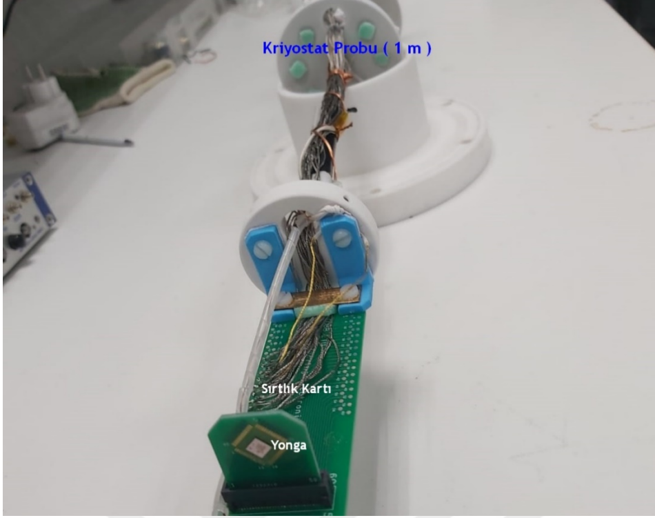
Şekil 1. 5: Baskı devre kartı ve probun entegrasyonu gösterilmiştir.
