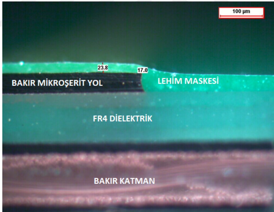
Resim 2. 2: BDK kesit görünüm, fotoğraf Leica DM6000M serisi mikroskop ile çekilmiştir.
