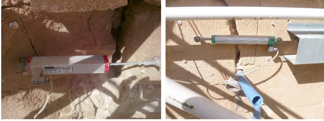
Resim 2.1 : Potansiyometrik cetvel ile yer değişimi ölçümü uygulamaları.
