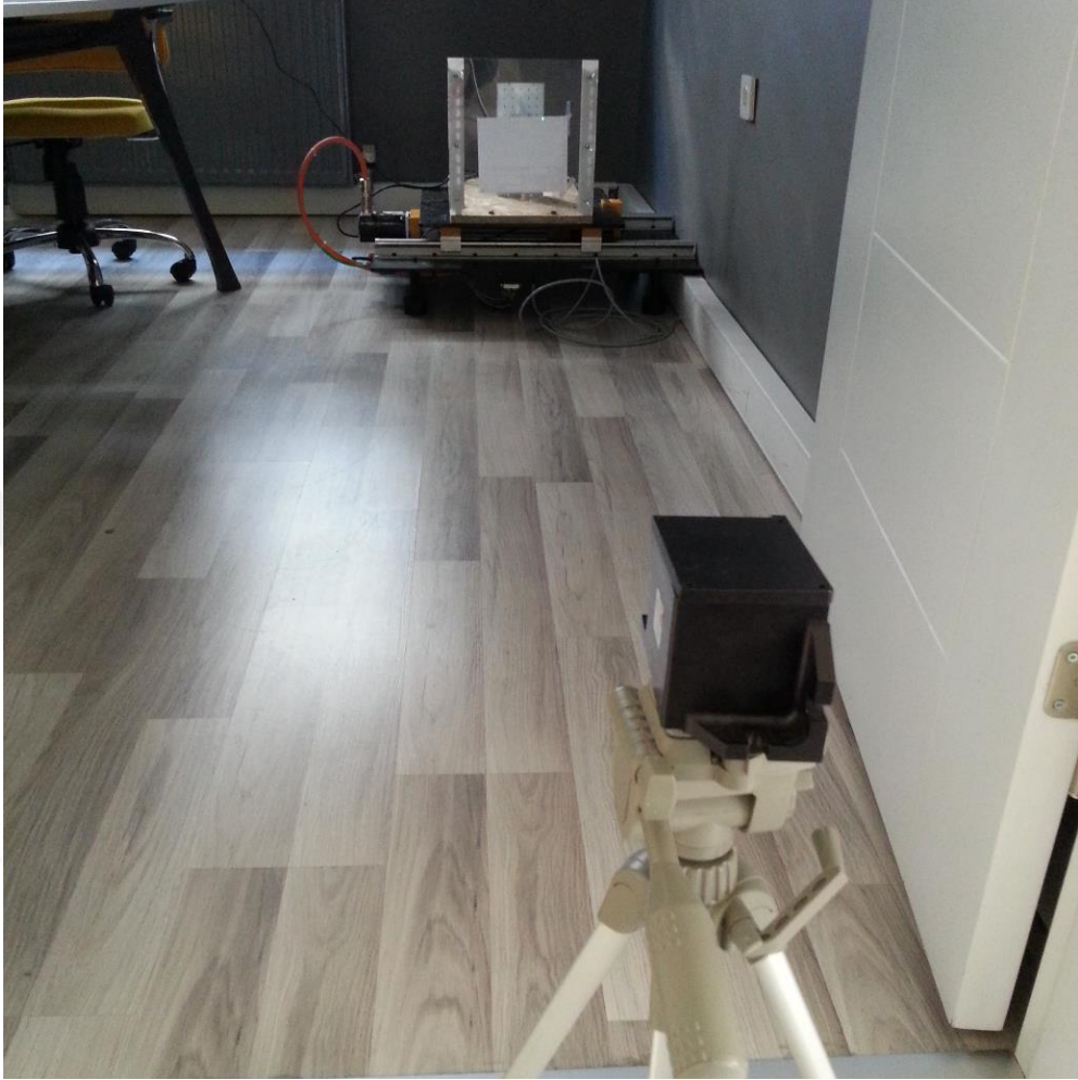
Resim 4.1 : Kamera hareketli, lazer işaretçi sabit kurulum resmi.
