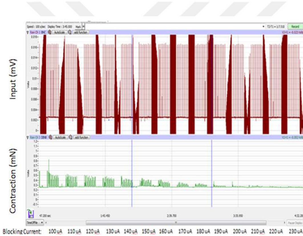
Şekil 2.7 : Yalın elektrot (Bare elektrot) bloklama deneyi
