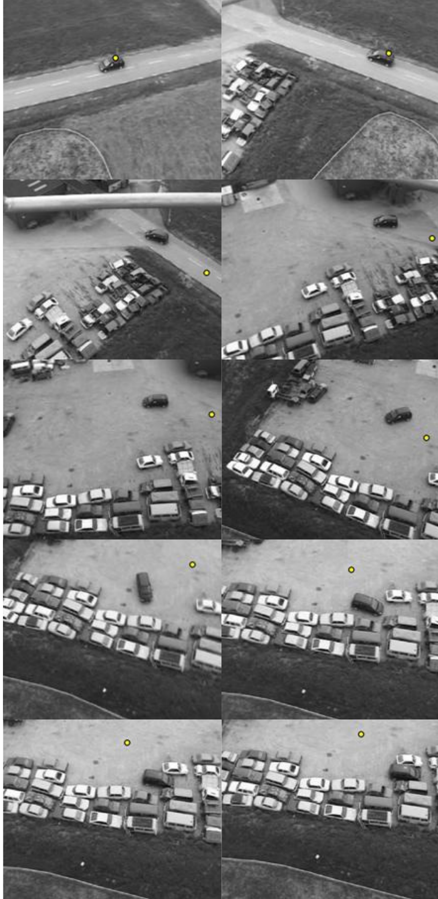
Şekil 6.15 NÇK şablon eşleme yönteminin takip sonuçları
