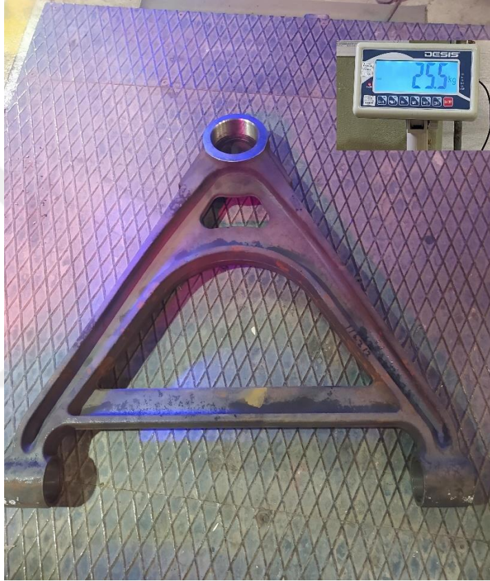
Resim 3.1 : Üretilmiş başlangıç tasarım kontrol kolu tartım sonucu.
