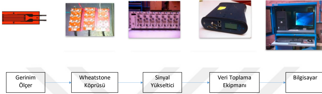
Şekil 3.11 : Gerinim ölçer ile örnek ölçüm akışı gösterimi [58].
