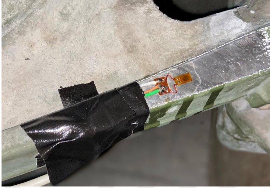
Resim 3.2 : Parça üzerine yerleştirilen gerinim ölçer.
