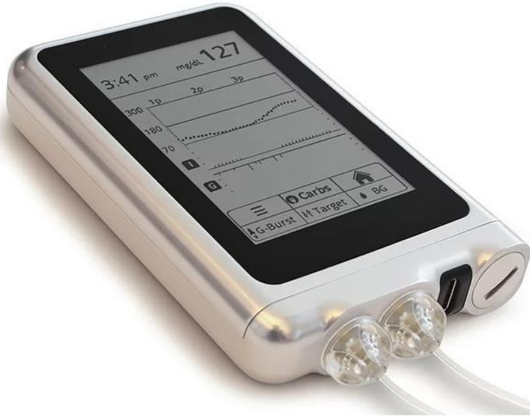
Resim B.3: Çift hormonlu Beta Bionics iLet biyonik pankreas[155].
