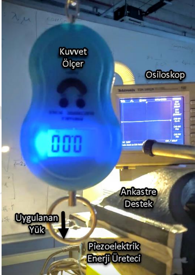
Şekil 6.5: Piezoelektrik enerji hasadı test düzeneği.
