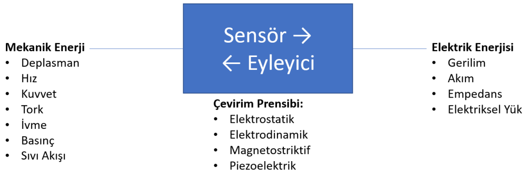
Şekil 1.6: Enerji çevirim prensibi.
