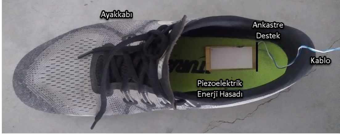
Şekil 6.6: Ayak tabanında piezoelektrik enerji hasadı.
