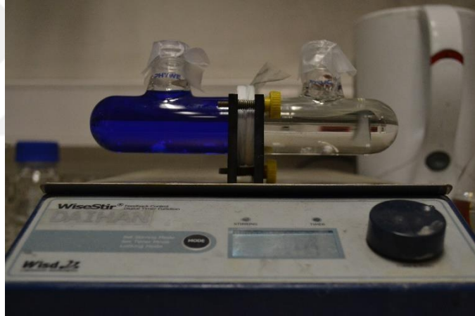
řekil 3.8 : Vanadyum geçirgenliđi ölçümünde kullanılan konsantrasyon hücresi
