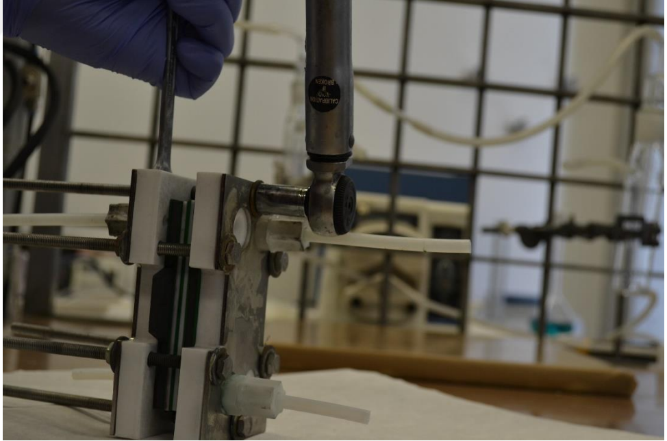
Şekil 3.26 : Torkmetre yardımıyla hücrenin sıkıştırılması
