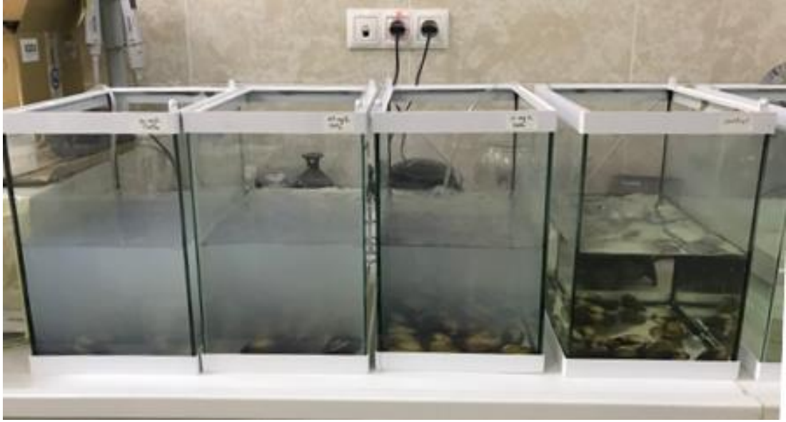
Şekil 3.3 : İlk gün sağdan sola; kontrol, 10 mg/L, 25 mg/L ve 50 mg/L nano CeO 2 ile dozlanmış akvaryum görüntüleri.
