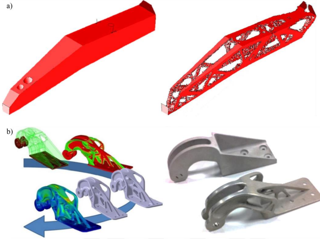
Şekil 2.2: TO ile elde edilen a) Airbus A350 pylon tasarımı, b) Airbus A320 Nacelle braketi
