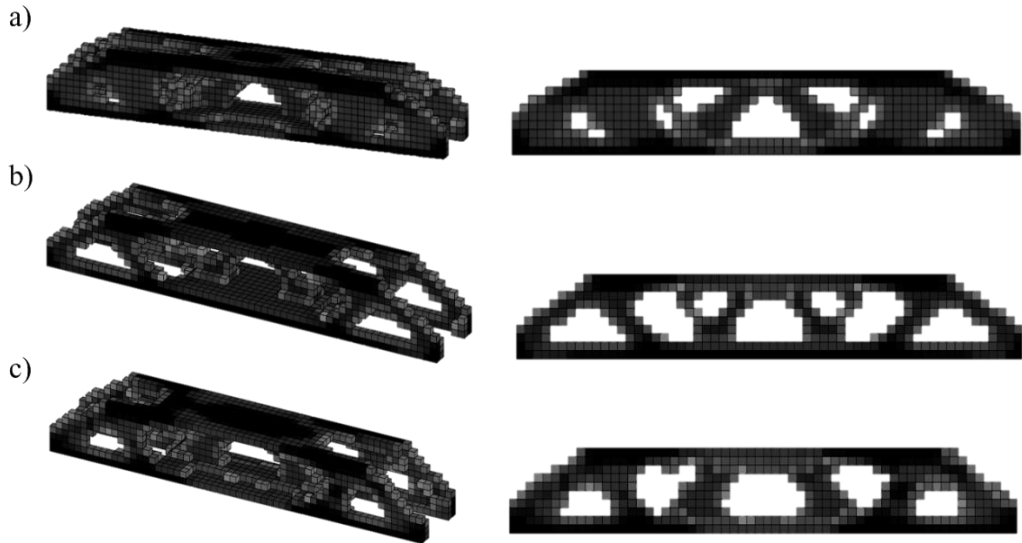
Şekil 4.42: Elde edilen MBB kiriş tasarımları a) GTO, b) YTO (APPTO'da kullanılan tasarım) ve c) EPPTO
