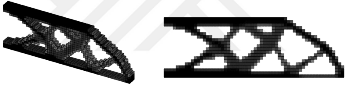
Şekil 4.18: GTO ile elde edilen optimum ankastre kiriş tasarımı
