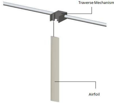
Şekil 2.1 PGH deney düzeneği travers mekanizması.
