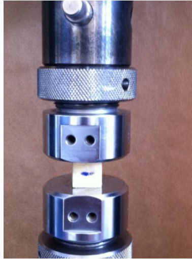
Şekil 2. 9: Basma Testi Düzenegi
