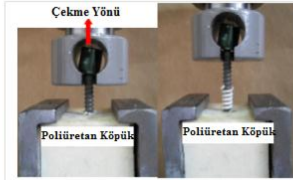
Şekil 2. 12: Çekip Çıkarma Deney Düzeneği
