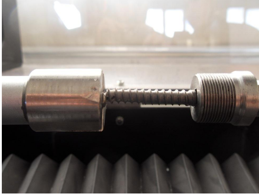
Şekil 3. 6: Tek taraflı çift delik açılmış numunenin kırılma fotoğrafı
