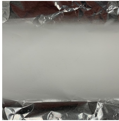
Şekil 4.1 : Alüminyum folyo üzerinde 3 saat biriktirme süresi sonrası AL-BSA doku iskelesinin görüntüsü.
