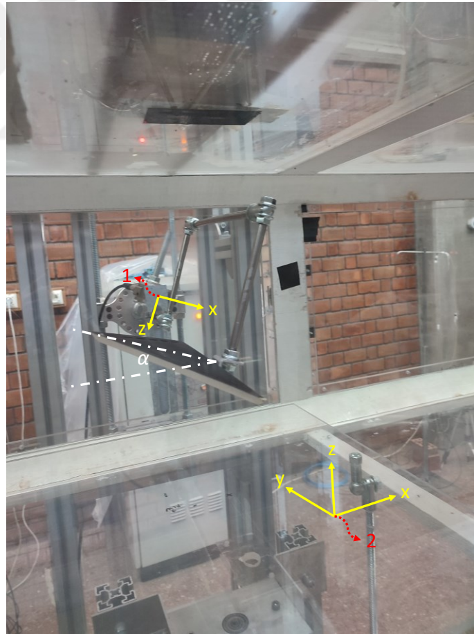
Şekil 3.10: Sensör hareketli eksen takımı (1) ve tünel sabit eksen takımı (2).
