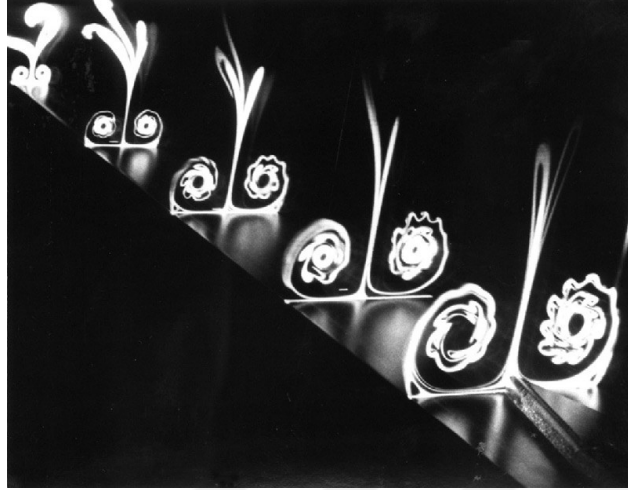
Şekil 2.2: 85 derece ok açılı bir delta kanadın öncü kenarı girdapları [37].
