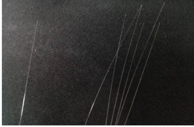
Şekil 3.6: 6 adet pompa ve 1 adet sinyal fiberi
