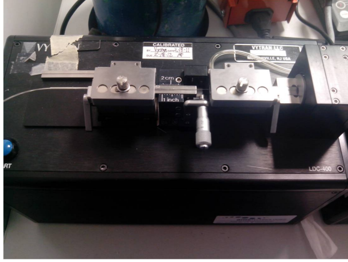
Şekil 3.8: Tüp ucunun "0" açılı kesilmesi
