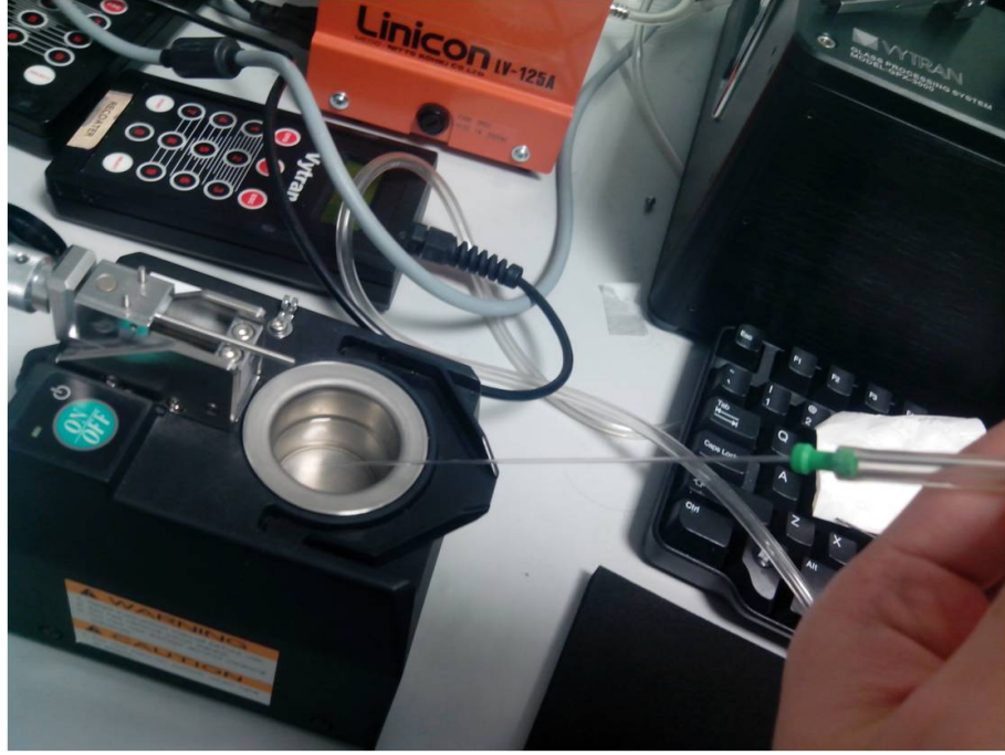
Şekil 3.5: Cam tüpün temizlenmesi
