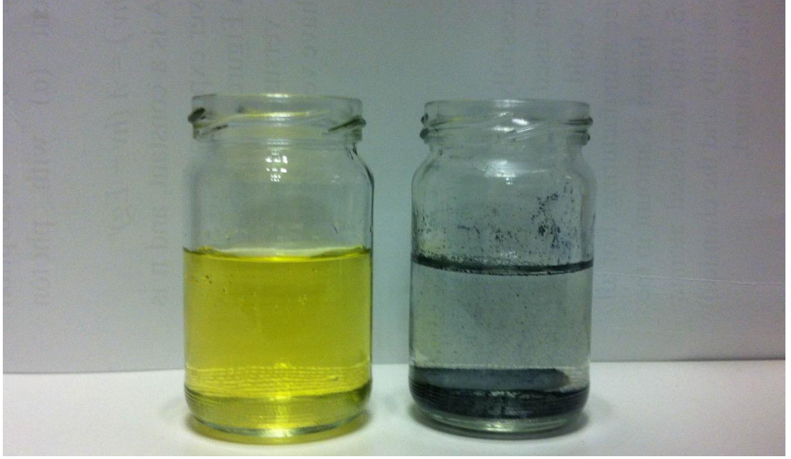
Şekil 3.6. Kesikli adsorpsiyon deneylerinin fotoğrafı a) Adsorpsiyon başlamadan önce b) Adsorpsiyon tamamlandıktan sonra
